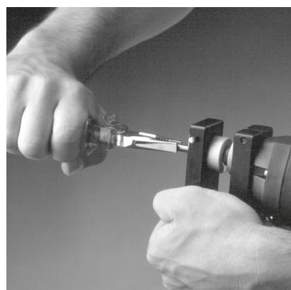
Es ist zu beachten, dass nach einem leer durchgedrückten und in der Setzlehre verbliebenen beziehungsweise nicht verankerten Stahlknopf beim Zurückziehen des Schrauber-Einsatzes automatisch der Streifen um einen Stahlknopf nachfolgt. Würde nun erneut der Schrauber-Einsatz nach vorne gedrückt, lagern zwei Stahlknöpfe übereinander, was zu Lade- und Setzstörungen führt.
