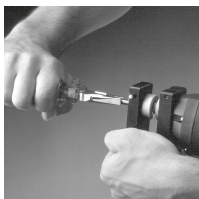
Après avoir enfoncé un bouton en acier à fond, ce dernier reste dans le gabarit ou n'est pas ancré et un autre bouton en acier suit automatiquement sur la bande lors du retrait du jeu de tournevis. Si l'on appuie à nouveau vers l'avant sur le jeu de tournevis, deux boutons en acier se superposent, provoquant ainsi des problèmes de charge et de pose.
