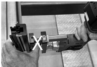
Um Quetschverletzungen während des Bohr- bzw. Schraubvorganges zu vermeiden, sind die Finger ausserhalb des Schraubvorsatzgerätes zu behalten! Außerdem kann sich der Bohrer während des Gebrauchs stark erhitzen – es besteht Verbrennungsgefahr bei Berührung!
