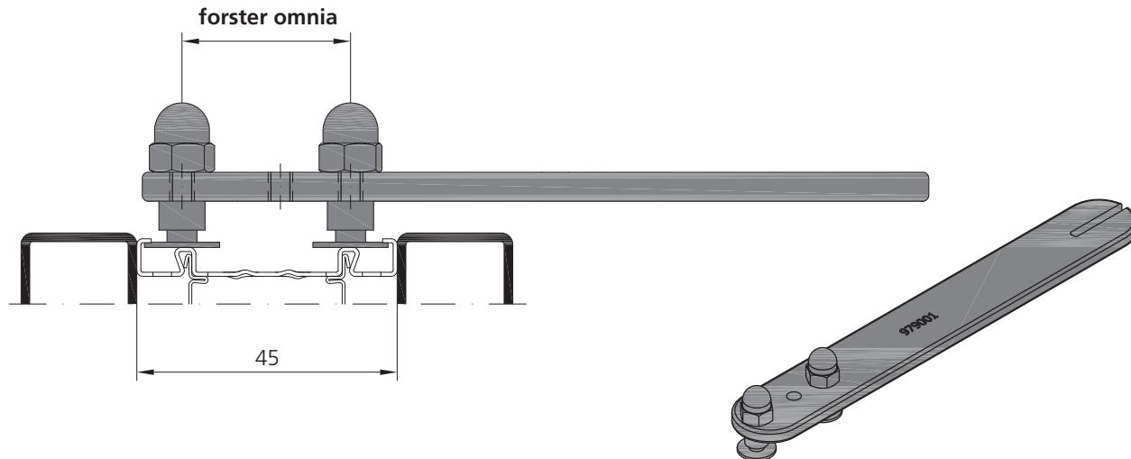
Den Richthebel diagonal ansetzen und in Pfeilrichtung ziehen (von Hand, nicht mit dem Hammer), um die Profilschalen ausseinanderzudrücken.
